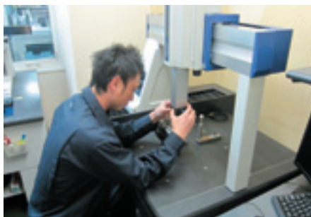
加工が終わった製品の仕上がりを 三次元測定器で計測
